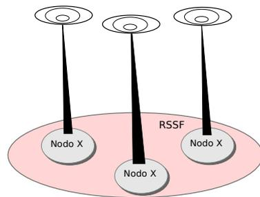
A ideia da cooperação em RSSF é transformar essa rede em uma espécie de “MIMO virtual”. Na área de telecomunicações, os dispositivos MIMO (Multiple Input, Multiple Output) são construídos com múltiplas antenas com propósito de aumentar a diversidade cooperativa (lado esquerdo da figura ao lado).
