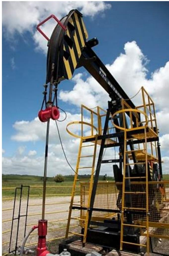
Fig. 1: Unidade de bombeio mecânico, típico de campos onshore.
