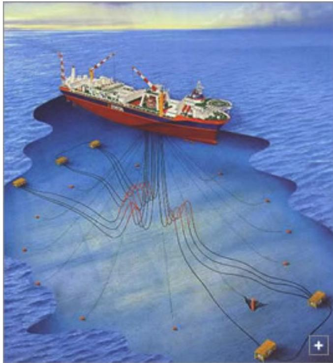
Fig. 1: Unidade flutuante de produção (Floating Production Storage and Offloading - FPSO) é um tipo de navio utilizado pela indústria do petróleo para a produção, armazenamento e transferência de petróleo. Na figura são mostrados os risers de conexão entre a FPSO e as cabeças dos poços.
