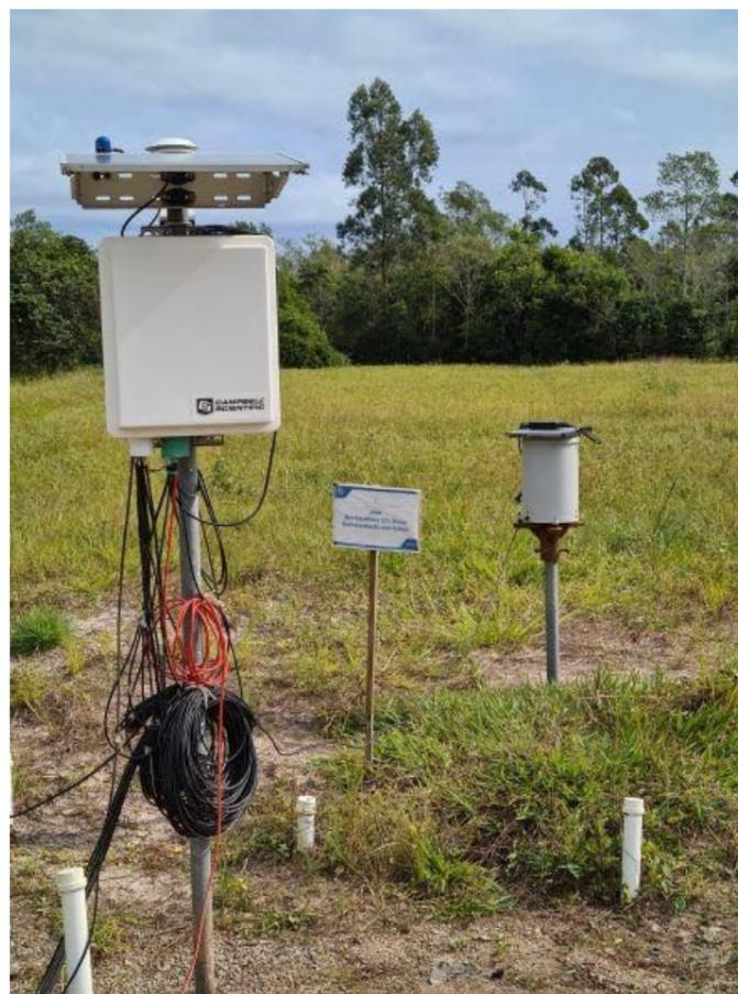
Figura 1: Sistema de monitoramento de fontes de contaminação instalado em área contaminada com gasolina e etanol.
